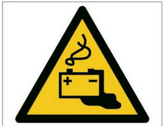
ISO 7010-W026, Warnzeichen für Warnung vor Gefahren durch das Aufladen von Batterien
